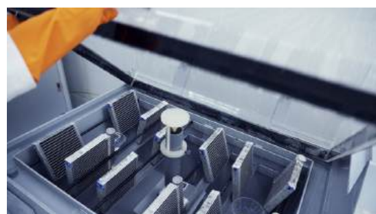
* Thử nghiệm ăn mòn tại Underwriters Laboratory (UL), Thái Lan
