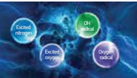
Các electron va chạm và kết hợp với nitơ và oxy trong không khí tạo thành bốn loại nguyên tố phân hủy có sức mạnh phân hủy.
