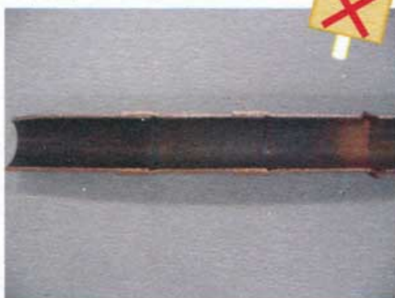
Không thổi nito Mặt trong ống bị đen do lớp ôxít
